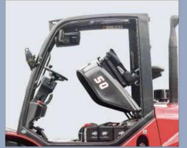
Maschine durch leicht zu öffnende Klappe zugänglich.
