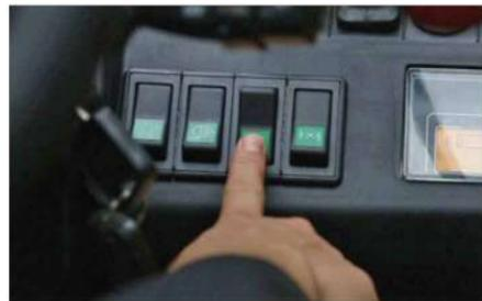
Hydraulische Getriebeübertragung mit elektronischer Entkopplung, so dass auf Knopfdruck zwischen Zweirad- und Vierradantrieb hin und her geschaltet werden kann. Höhere Geschwindigkeit und Steigfähigkeit.
