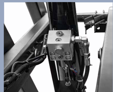
Explosionssgeschütztes Ventil zum Schutz vor Unfällen bei Ölaustritt
