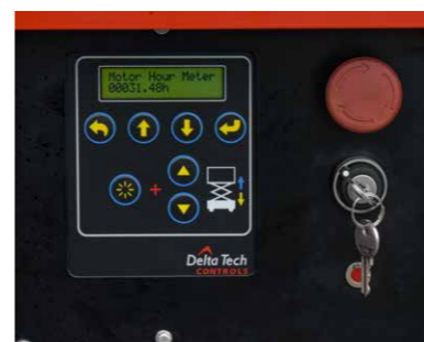
LCD - Anzeige für Einstellparameter und Fehlermeldungen.
